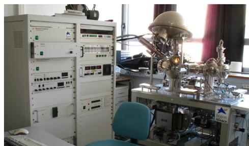
Il s'agit d'une technique très fine permettant d'avoir accès à la composition chimique de tous types de matériaux solides sur une profondeur d'environ 10 nanomètres. Elle permet également de déterminer le degré d'oxydation, et surtout l'environnement de ces atomes et la nature de leurs liaisons chimiques avec leurs plus proches voisins.
