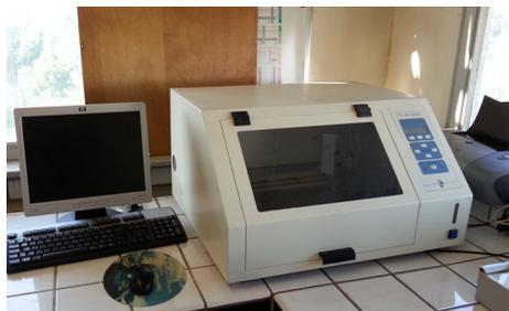
L'Institut de Biologie Moléculaire des Plantes s'est équipé d'un scanner de radioactivité pour l'analyse enzymatique de plantes exposées à des polluants atmosphériques. Cet appareil permet de détecter et de positionner très précisément, après séparation par chromatographie en couche mince, des composés produits à partir de substrats radioactifs lors de réactions chimiques ou enzymatiques.
