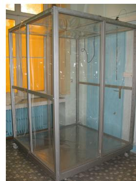
*Analyseurs de CO, NO<sub>x</sub> et O<sub>3</sub> à gauche couplés à une chambre réactionnelle à droite*
