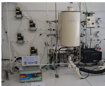
*Banc de test catalytique*
