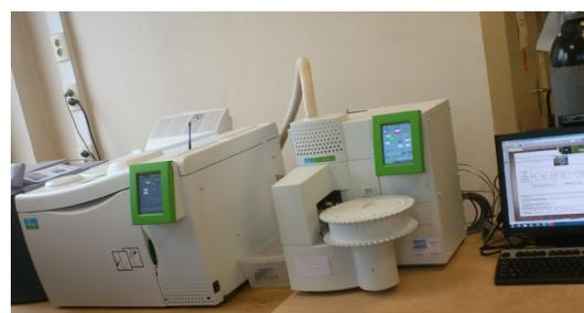
*GC/FID couplé à un thermodésorbteur pour l'analyse de Composés Organiques Volatils*
