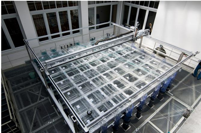
Ce pilote est une maquette d'une taille de 5 mètres sur 5 mètres, représentant un quartier composé de 14 rues, chacune alimentée par une pompe individuelle. Cette plateforme expérimentale permet de reproduire en laboratoire la propagation d'une crue à travers un quartier virtuel. La géométrie choisie ne correspond pas à un quartier existant, mais représente un quartier européen moyen. Ce pilote permet de tester divers type de régimes permanents et transitoires.
