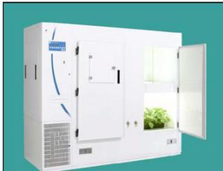
Cette chambre de croissance permet la culture de plantes et l'étude d'associations plantes-microorganismes en conditions contrôlées de lumière (intensité, périodicité), de température (chauffage et refroidissement) et d'humidité, grâce à un module de contrôle informatisé.
