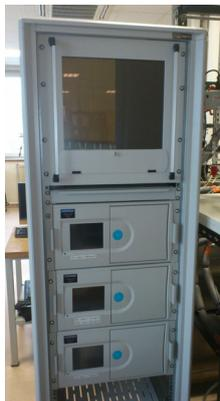
Une chambre réactionnelle a été instrumentée au moyen d'analyseurs de monoxyde de carbone, d'oxydes d'azote et d'ozone qui permettent de suivre les concentrations en temps réel. Tous les moyens analytiques acquis par la suite peuvent être également couplés à cette chambre réactionnelle qui permet notamment de générer des mélanges représentatifs des concentrations rencontrées dans l'air ambiant.
