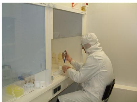
L'analyse des rapports isotopiques par spectrométrie de masses des échantillons naturels nécessite de traiter ces derniers au préalable en salle blanche pour isoler, généralement par chromatographie ionique et par mise en solution par attaque acide, les éléments chimiques à analyser.
