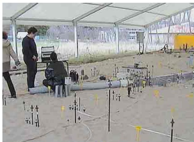
*Équipement de SCERES en capteurs de pressions différentielles de l'air du sol et de cannes gaz*
