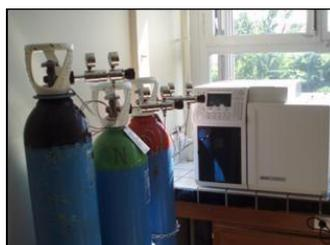
Cet équipement sert à l'analyse quantitative des composés chimiques volatils. Il permet le suivi des méthanes chlorés (chlorométhane, dichlorométhane, tetrachlorométhane) dont la dégradation par les bactéries est étudiée par l'équipe.
