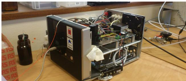
**Figure 1:** Prototype de seconde génération de l'analyseur. Le prototype est transportable (env. 8 kg) et a une dimension de 28,5 x 23 x 38 cm.
