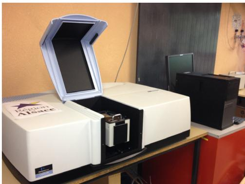
Le spectromètre UV-Vis (Perkin Elmer Lambda 950) permet de suivre, en fonction de la température, les transferts d'électrons entre les espèces adsorbées et l'adsorbat. Cette acquisition est très innovante par le fait que nous avons introduit dans le cahier des charges des demandes très spécifiques liées à nos besoins en catalyse hétérogène. Cet appareil va être couplé à court terme à un « bâti » spécial acheté dans le cadre d'une ANR visant la valorisation de l'énergie décarbonée.
