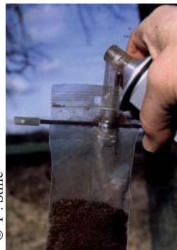
Echantillonnage des écorces : la profondeur de l'échantillonnage est de 1 mm (procédé breveté).
